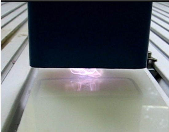
Úprava PP povrchu atmosférickou tryskou
