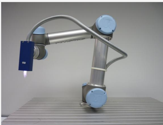
Umístění trysky na robotu (Universal Robots)
