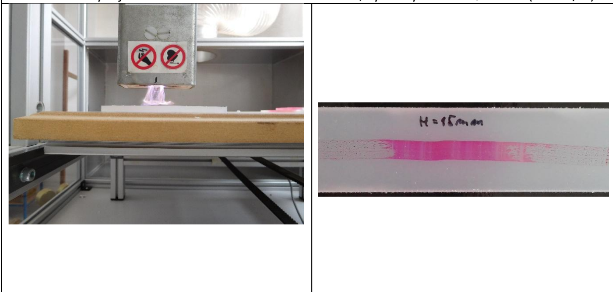
Obr. 5 a 6: Výboj ve vzdálenosti H = 15 mm od substrátu, výsledky měření Quicktest (38 mN/m)
