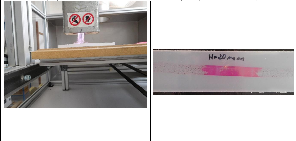
Obr. 7 a 8: Výboj ve vzdálenosti H = 20 mm od substrátu, výsledky měření Quicktest (38 mN/m)
